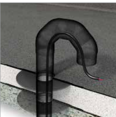
Einbaubeispiel: Flavent® zweiteiliges Dachdurch- führungs-Set im unbelüfteten Dach mit Bitumendachbahn
